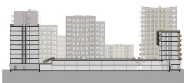
Doorsnede met parkeergarage in bouwblok 1I ©GROUPA
